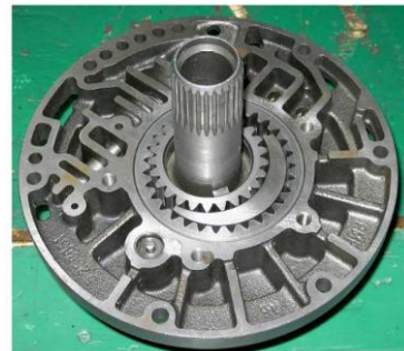
pompa zębata z zaworem sterującym (skrzynia biegów)
